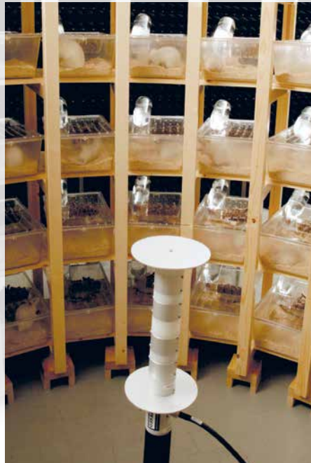
Aus Holz gebautes Expositionssystem für Versuchstiere der Ramazzini-Studie 12 , vgl. Bildlegende S. 19. © zvg
